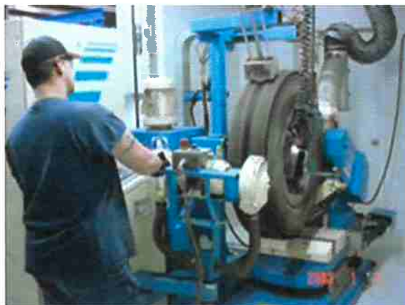
Figura 5: Processo de raspagem da carcaça do pneu. Fonte: https://www.pneusfacil.com.br/info/passo_de_remold
